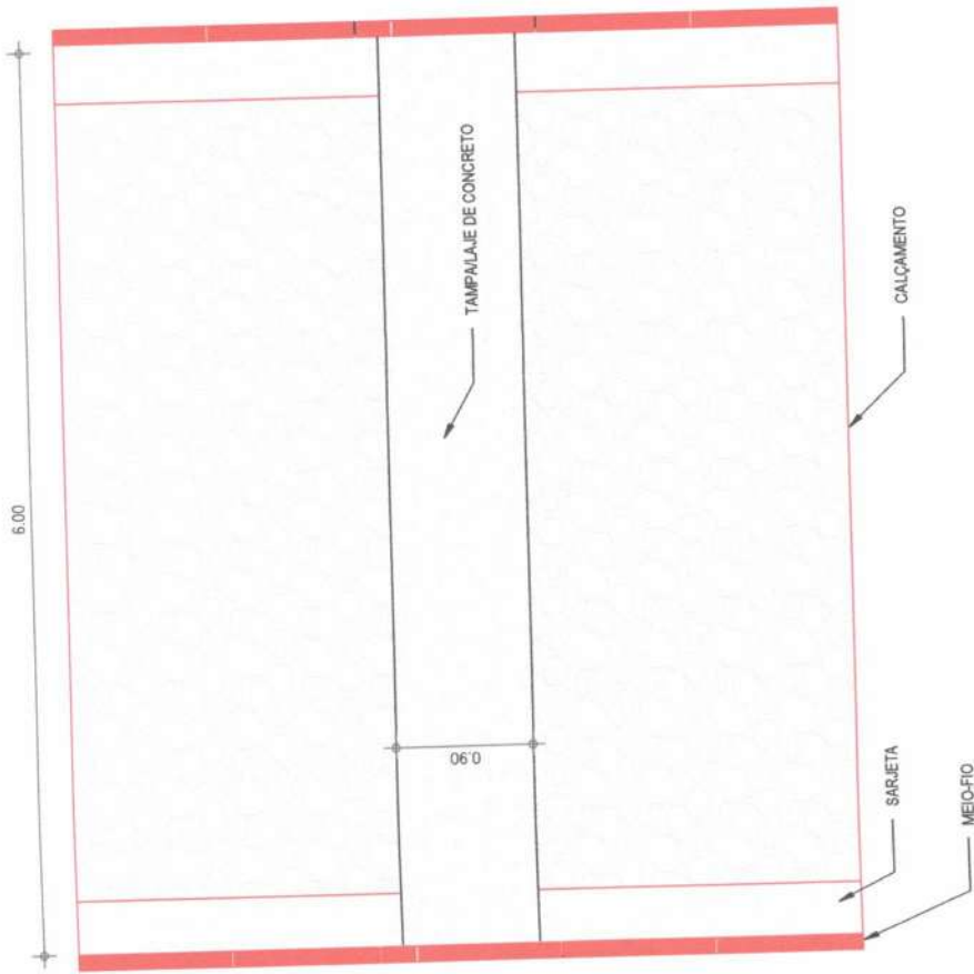
01 | PLANTA DE VALA EM CALÇAMENTO ESCALA 1:50C
