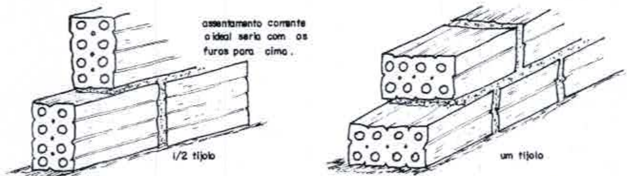
Figura 1 - Execução de alvenaria utilizando tijolos furados.
